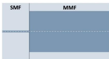
Рис. 3.3. Структура одномодовое волокно–многомодовое волокно (SMF–MMF-структура или SM-структура) в MMI-устройствах [10]
