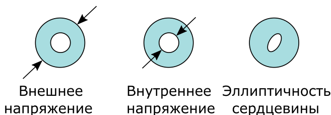
Рис. 1.12. Причины возникновения двулучепреломления в волокне
