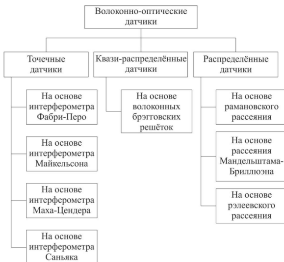
Рис. 3.1. Классификация ВОД по критерию протяженности чувствительного участка [9]
