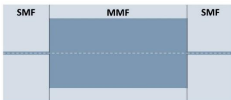
Рис. 3.4. Структура одномодовое волокно–многомодовое волокно–одномодовое волокно (SMF–MMF–SMF-структура или SMS-структура) в MMI-устройствах [10]
