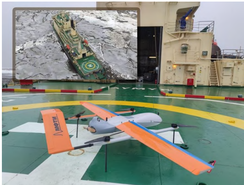
Фото. Испытания комплекса оперативной ледовой разведки на борту атомохода «Гаймыр», 21-23 июня 2023 г.
